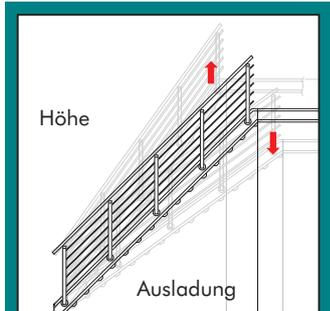
Durch drei Längsvarianten und entsprechende Ausladung kann **KombiASS** zentimetergenau und ohne Nacharbeiten an die jeweilige Höhe angepasst werden.
