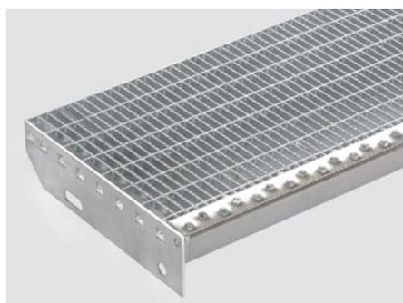
Mit Sicherheitsantrittskante und angeschweißten Seitenbacken aus Flachstahl 70/3, Bohrungen nach DIN 24531.
